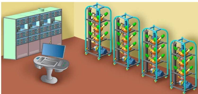
Рис. 9. Внешний вид опытно-промышленной установки «Поток 7МИ-200». Кабели, трубопроводы и система охлаждения – не показаны.
