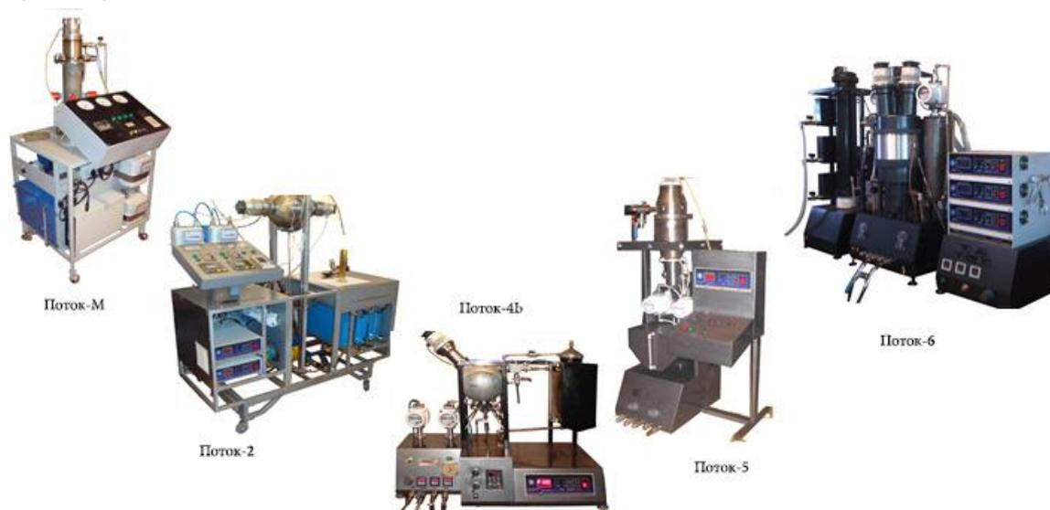
*Рис.8. Внешний вид некоторых установок серии «Поток», реализующих технологию кавитационного гидрирования углеводородов.*
