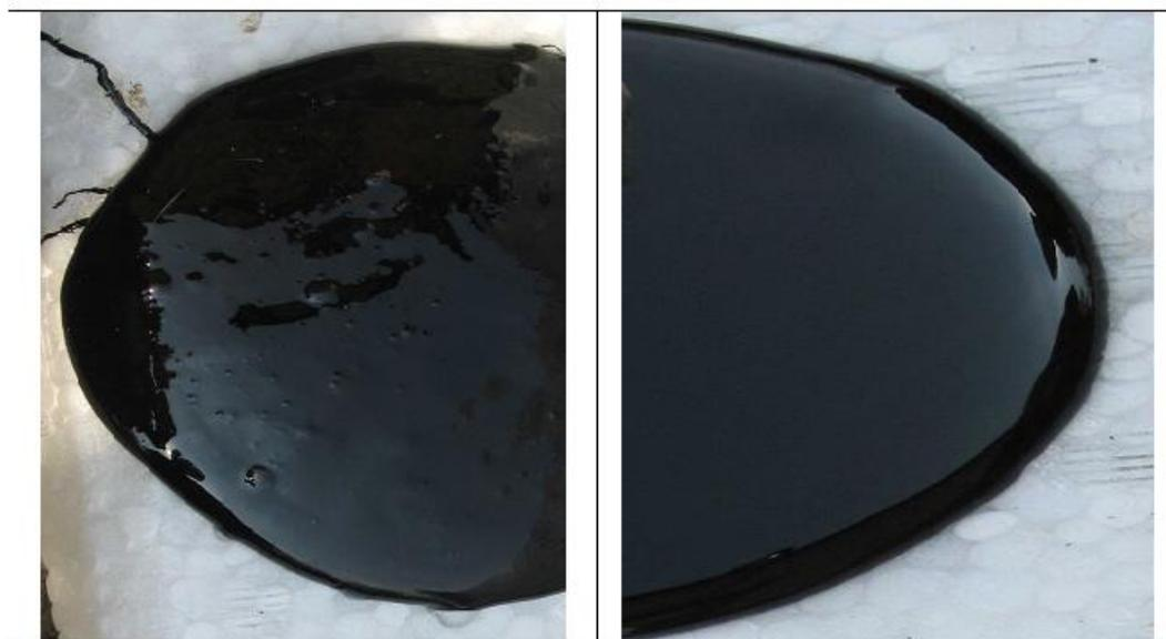
*Рис.1. Фотографии проб исходного мазута длительного хранения (слева) и того же мазута после кавитационной обработки (справа)*
