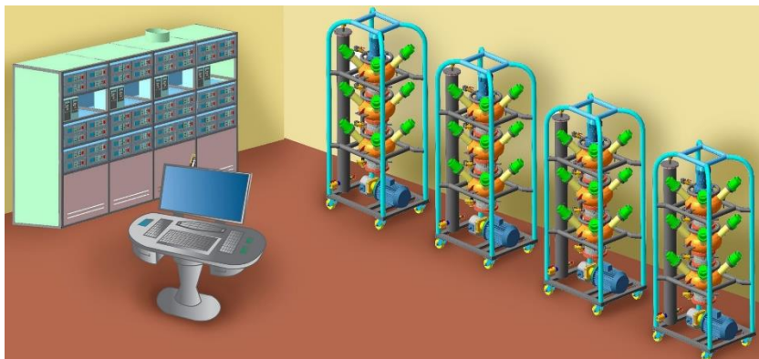
Мал. 2. Зовнішній вигляд системи кавітаційного гідрування вуглеводневої сировини «Поток-7МИ-200». В основу покладені реактори тороїдального типу, а 48 випромінювачів – пьезострикційного типу. Установка обладнана системою моніторингу і керування, насосами та датчиками.
