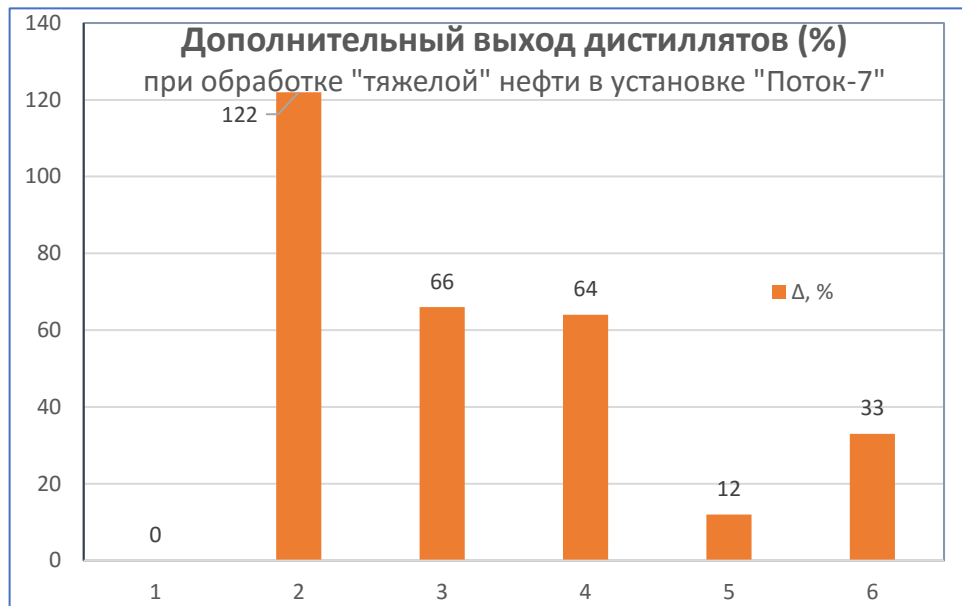
Рис. 22. Результаты разгонок образцов «тяжелой нефти», предварительно обработанного на кавитационной установке «Поток - 7». Разгонки осуществляли на аппарате АРНС-1М. В правой стороне предыдущего рисунка обозначены легенды исследованных 6 образцов углеводородов. Если исходная нефть выкипает при 295°С в объеме, примерно 21%, то 5-й образец этой же нефти, обработанной при других условиях, выкипает при
