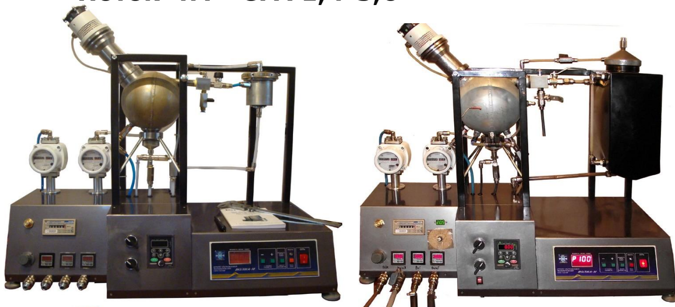
Рис. 5. Внешний вид малогабаритной презентационной лабораторной установки Поток -4М. Справа – эта же установка, что и слева, которую модифицировали в процессе настроечных работ. Установка предназначена для поиска в лабораторных условиях оптимальных значений гидротермодинамических и акустических режимов ультразвукового каталитического крекинг – синтеза углеводородных соединений. Установка отличается от предыдущих использованием цифровых датчиков и отсутствием операционных емкостей. Инициаторы разработки: Конорезов В.В., Поздеев А.В., Войтович А.В.
