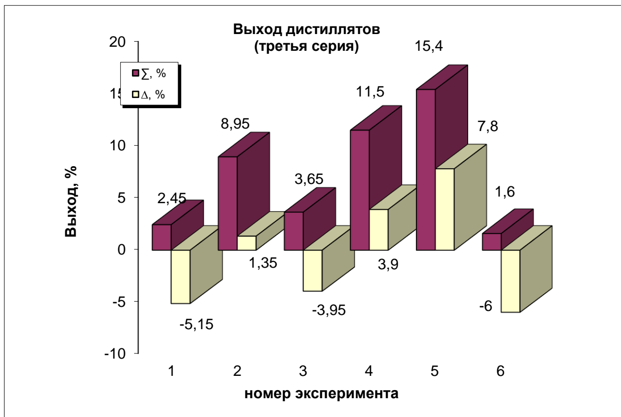
Рис. 14. Диаграмма результатов кавитационной обработки мазута М100 (производимого Кременчугском НПЗ). Показаны значения разгонки 6 образцов мазута, выполненные в 2013 г на установке «Поток-6».
