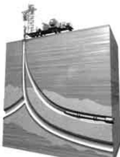
*Технология интенсификации разработки нефтяных месторождений высоковязкой нефти за счет детальной геологической разведки и экспертирования состояния нефтеизвлечения из залежи, целенаправленного бурения коротких горизонтальных стволов в "целики" нефти, внутрискважинного разжижения, контроля и управления добычей нефти из них.*
