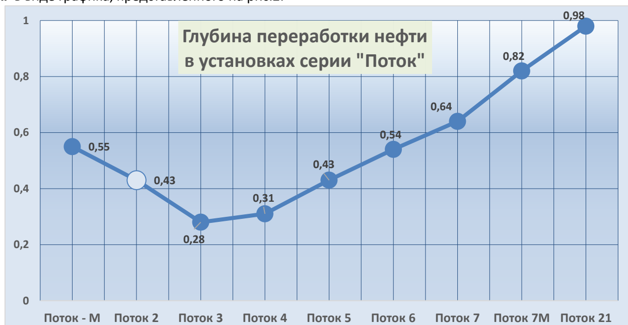
Рис. 2. Изменение глубины переработки нефтяного сырья, полученной на установках кавитационного гидрирования серии «Поток» в 2010 – 2019 гг. Величина этого показателя для установки «Поток - 21» - проектная.
