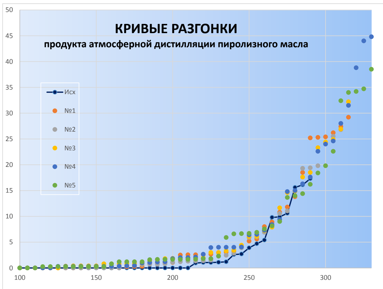
Рис. 7. Эффективность технологии кавитационного гидрирования для трансформации пиролизного масла, извлеченного из бытовых отходов. Следует отметить, что на этой диаграмме прослеживается положительная возрастающая тенденция увеличения дополнительного выхода дистиллятов в зависимости от верного выбора изменения технологических параметров. Кривые разгонок показывают, что максимальное достигнутое значение дополнительного выхода дистиллятов из отгона пиролизного масла из бытовых отходов, подвергнутого указанной технологии его обработки, составило 55,5% против 17,2% (см. рис. 6) в необработанном состоянии. Т.е. 37.9%.
