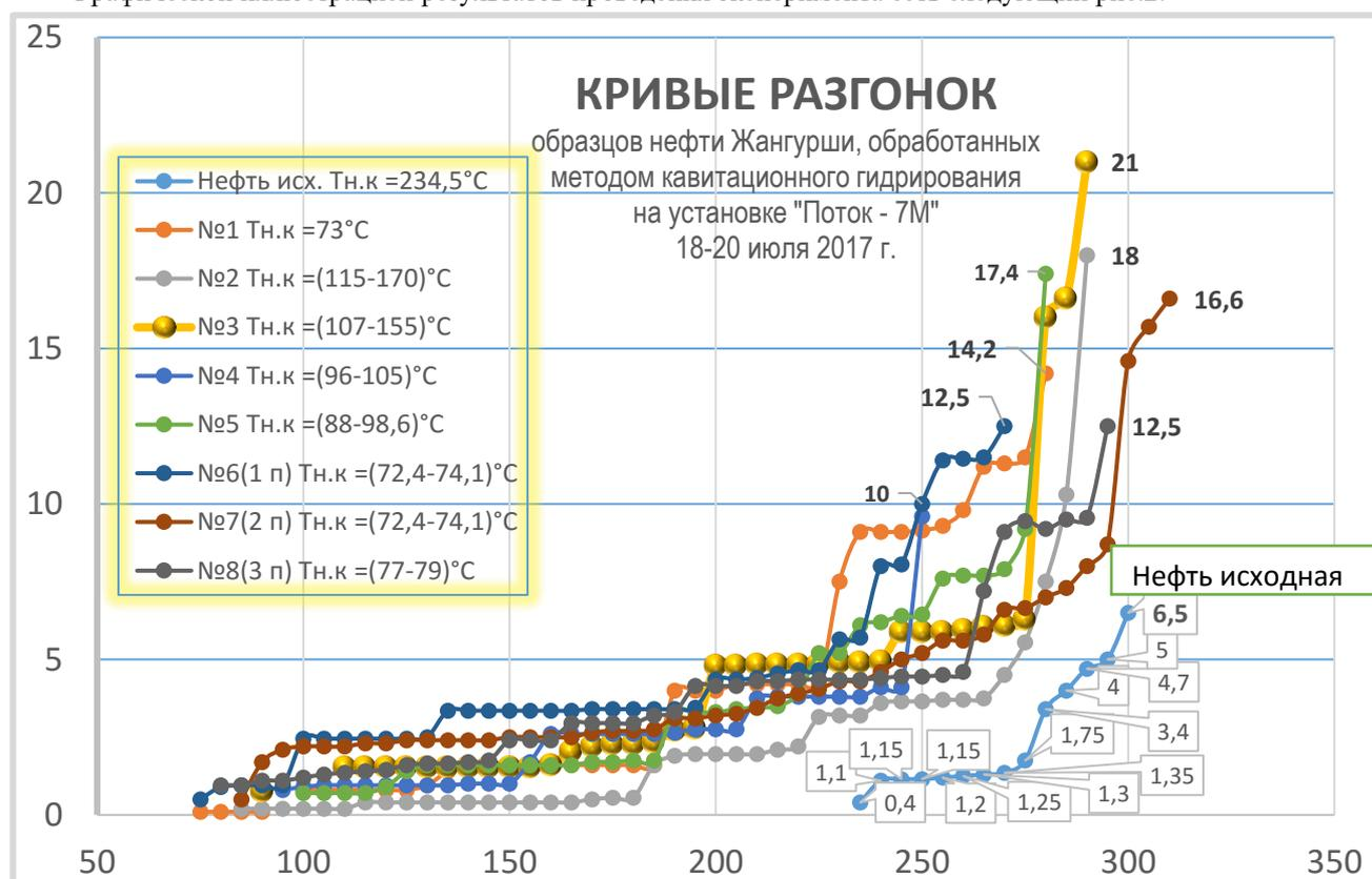
Рис.2. Кривые разгонок нефти месторождения Жангурши. Рисунок включает 9 кривых разгонок нефти, обработанной способом **КГ** (насыщения сырья атомарным водородом) на лабораторной установке «Поток 7М». Эксперимент проведен 18 – 20 июля 2017 г.
