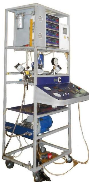
*Рис. 1. Внешний вид лабораторной установки «Поток-7М», которую использовали для реструктуризации нефти Жангурши.*
